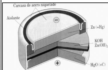
pila de mercurio
